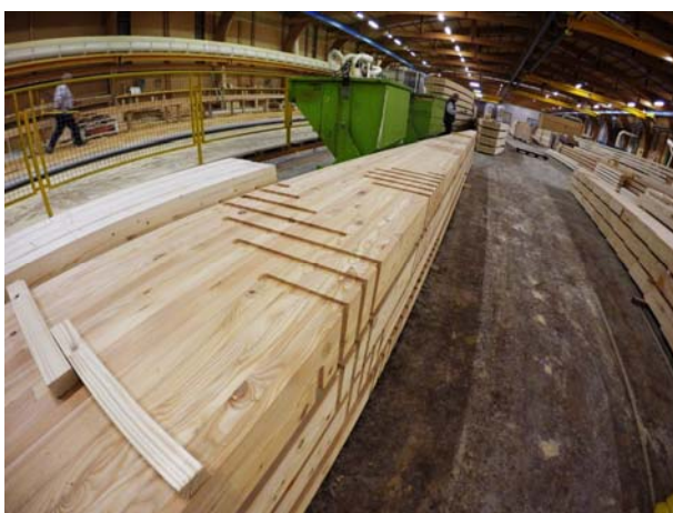
Fig 3. Pontre lamellé-collé en cours de fabrication et fraisage numérique pour l'anamorphose, atelier Arbonis.
