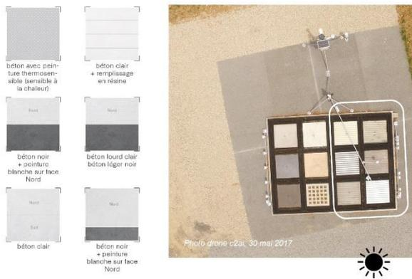
Fig 11. Les 6 échantillons innovants sur la partie droite de la table
